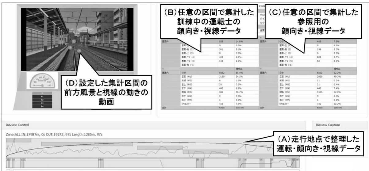
図1 運転シミュレータにおける視線データフィードバックシステムの画面例
