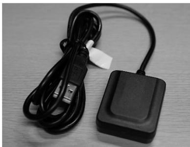
図1 USB 接続型衛星測位レシーバー
