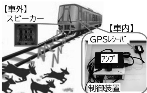
図 1 鹿忌避音装置の設置イメージ
