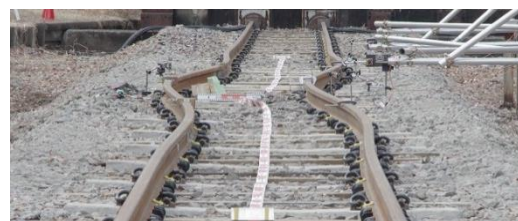
(b) 試験結果(増強工なし, \Delta t 42℃で座屈)
