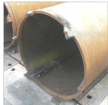
図2 先端リングビット付き鋼管杭<sup>2)</sup>
