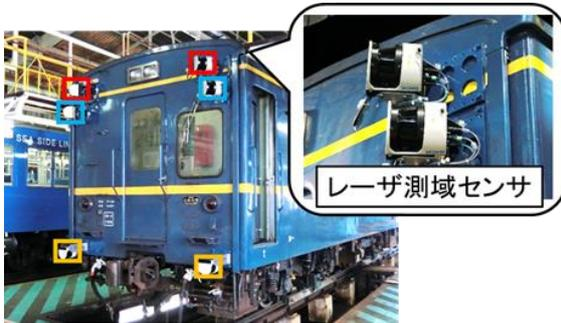
図 1 レーザスキャナの取り付け状況
