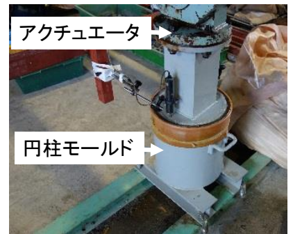
図 1 繰返し荷重の試験状況
