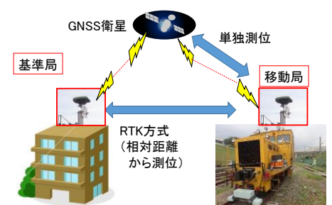
図2 衛星測位システムによる測位
