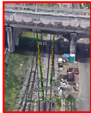
図 5 高架橋付近における RTK 方式による測位結果（写真は Google Earth より抜粋）
