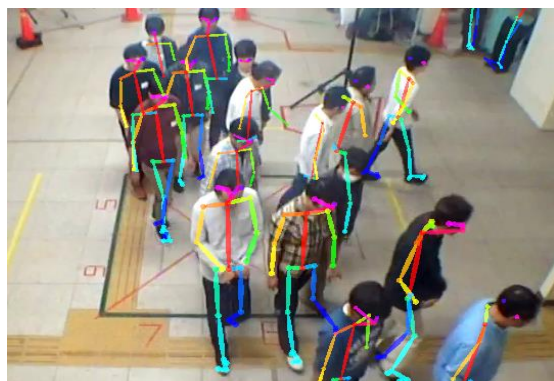
図5 AIを用いた断面交通量の計測例 3)
