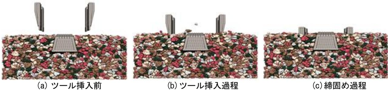
図3 タンピング作業の再現シミュレーション
