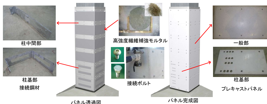
図 2 繊維補強モルタル巻立て工法の概要
