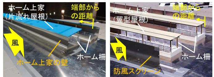
図2 風洞試験の状況（地平ホーム）
