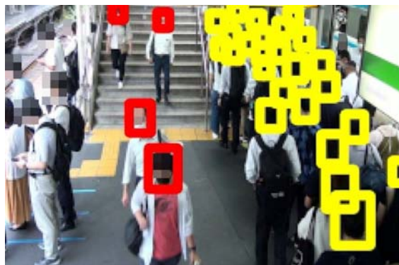
図5 YOLO 3 )による断面交通量の計測例
