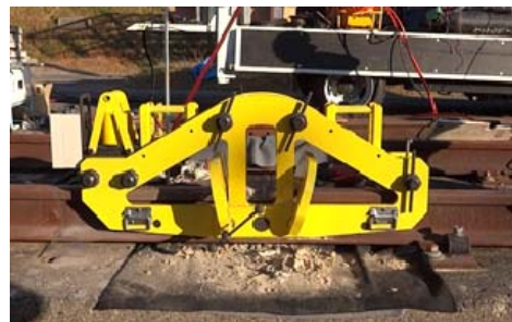
図 4 新型熱間矯正機による矯正試験状況
