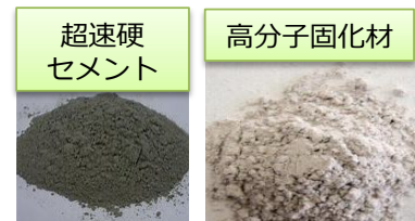
図1 低強度安定処理工法の補修材
