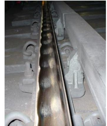
図1 レール波状摩耗の例
