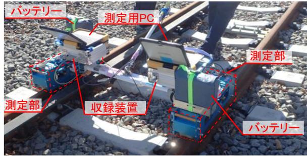
図5 左右レールを同時測定可能なレール凹凸連続測定装置（開発装置）
