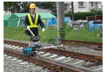
図2 レール凹凸連続測定装置
