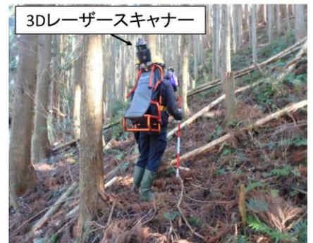
図 1 3D レーザーによる測定状況
