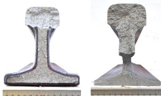
(a) HU 破断 (b) HD 破断
