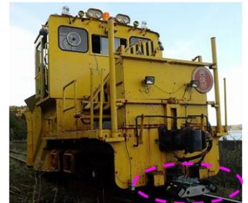
図1 動的軌間・平面性測定装置
