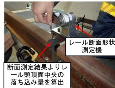
図5 レール断面形状の測定
