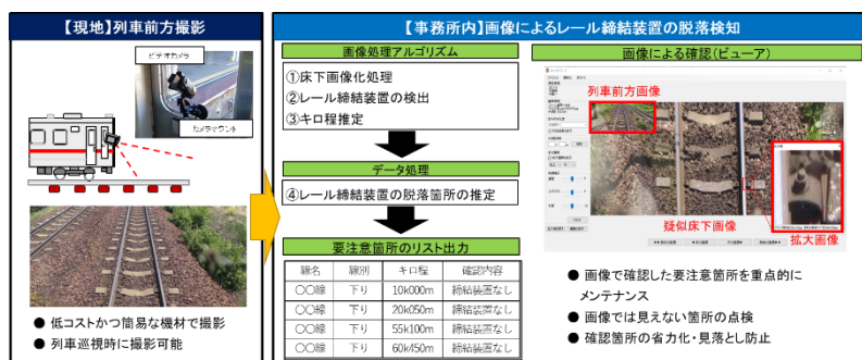
図1 列車前方画像を用いたレール締結装置の脱落検知手法の概要
