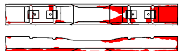
図 5 スケーリング箇所抽出例
