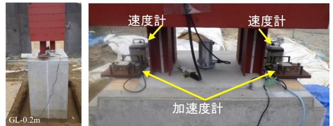
図2 掘削状況の例とセンサ設置状況（橋脚天端）
