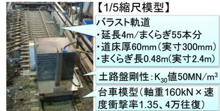
図4 小型模型の移動載荷試験状況
