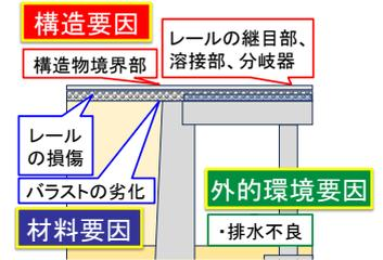
図1 バラスト軌道の沈下要因
