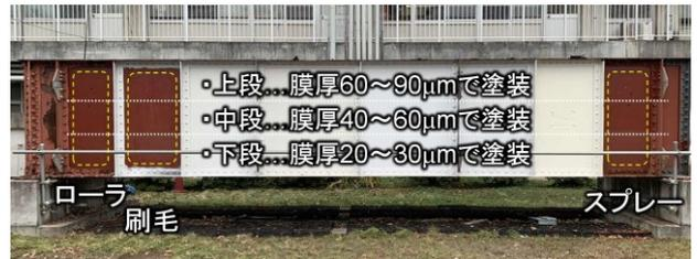
図 1 廃桁の切出し部材の外観と施工箇所
