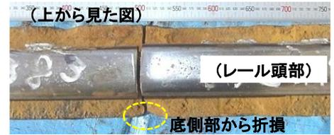
図1 底部が腐食し、折損したレールの例
