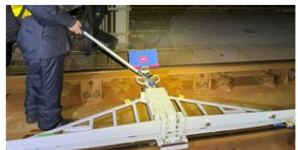
図 4 静的軌道変位の測定
