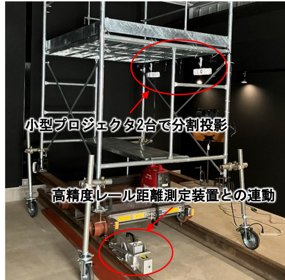
図3 投影装置の改良箇所
