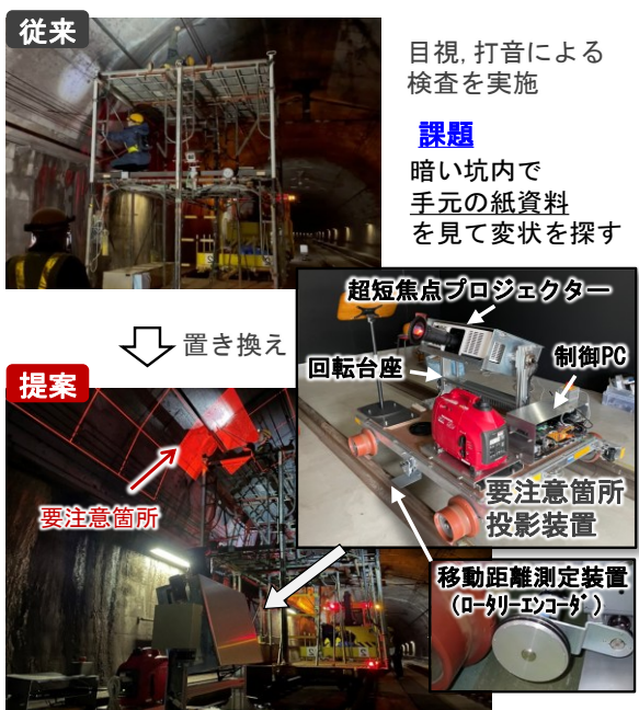
図2 要注意箇所投影装置の概要
