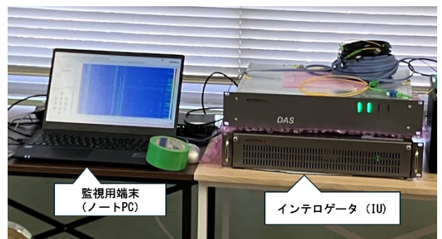
図 2 DAS の IU 及び監視用端末（ノート PC）
