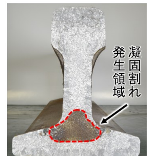
図 1 凝固割れ破面
