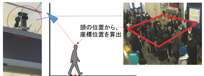
図2 俯瞰画像による流動解析の例
