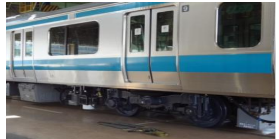
図 1 慣性正矢軌道検測装置搭載例
