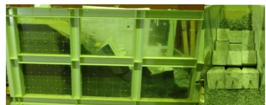
図3 崩壊後の石積み壁の様子（布積み）
