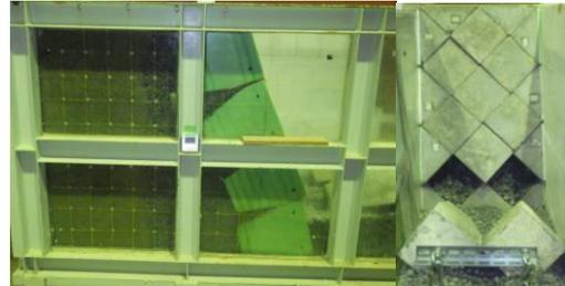
図5 崩壊後の石積み壁の様子（谷積み）
