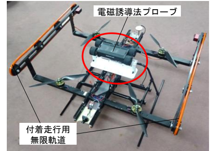
図 1 鉄筋探査装置を搭載した UAV
