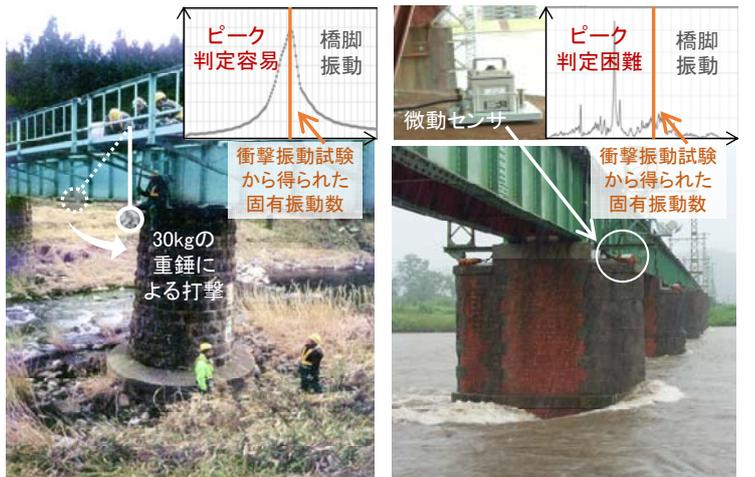
図2 衝撃振動試験の様子
