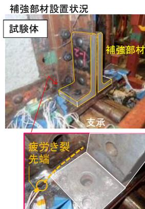
図4 補強部材設置状況
