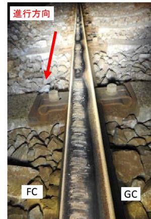
図1 中きしみ割れ発生箇所の外観
