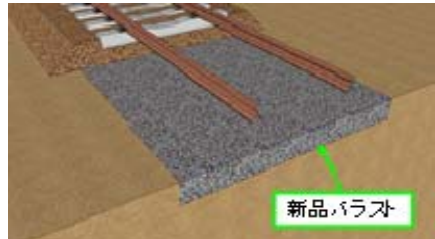
手順2 新品バラストの敷き詰め
