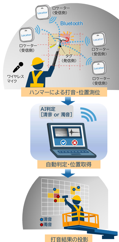
図3 要打音箇所・打音結果の投影技術
