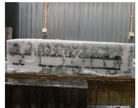
図5 融雪水の浸透試験の状況
