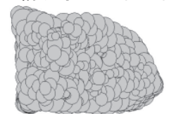
図2 球剛接バラスト要素の作成例
