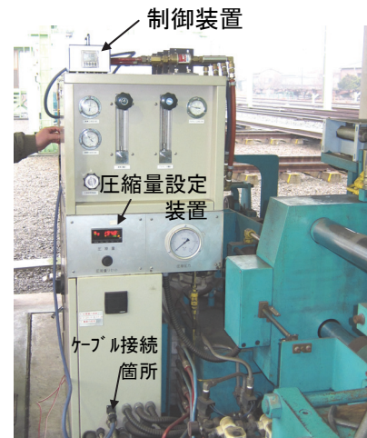
図2 制御装置の設置状況
