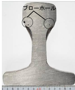
(b) ブローホールの発生状況
