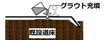
図 3 グラウト充填工法の概要
