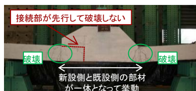
図4 接続部付近の破壊状況
