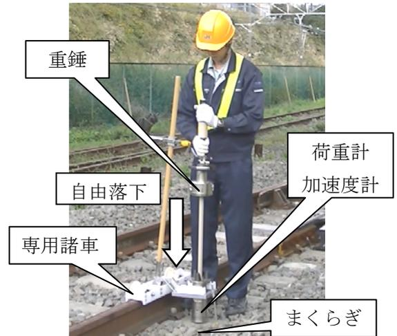
図 1 軌道上での小型 FWD 試験の状況
