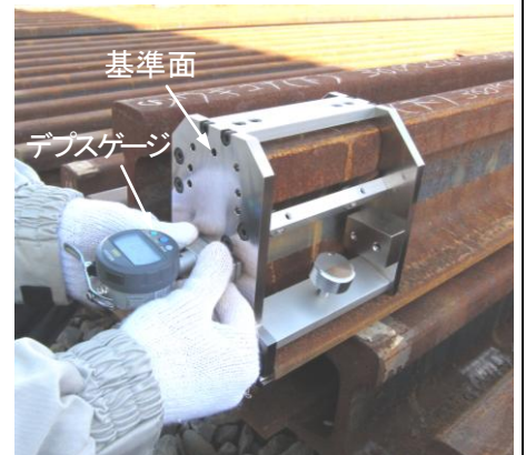
図 1 レール端面の平面度測定状況
