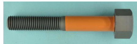
図7 熱収縮チューブによる被覆
