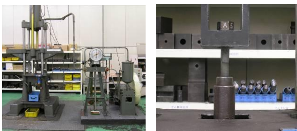
(a) 引張試験機 (b) ボルトの設置状況
