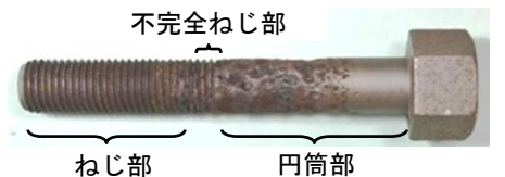
図2 敷設から約9年後のボルトの外観（さびを除去した状態）
