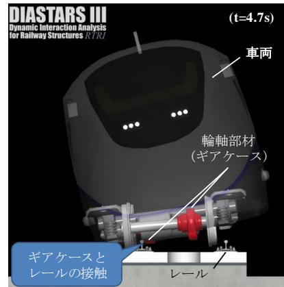
図6 接触状況(試算例1)
