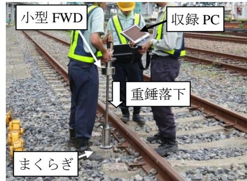
図 1 軌道支持剛性の測定状況の例
