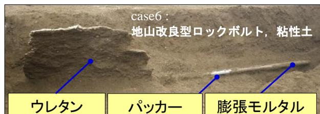
写真2 掘り起こしによる改良状況確認結果
