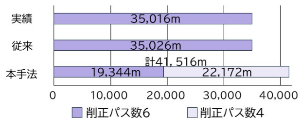
図 3 年間レール削正延長の比較
