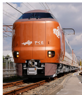
図7 次世代振子システムが搭載された273系振子車両
