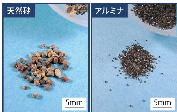
図1 砂まき器用の天然砂とセラジェット用のアルミナの比較
