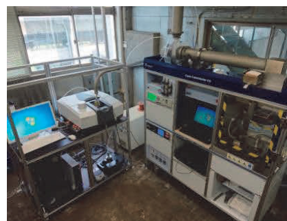
図3 CCM-IR試験装置の外観 6)
