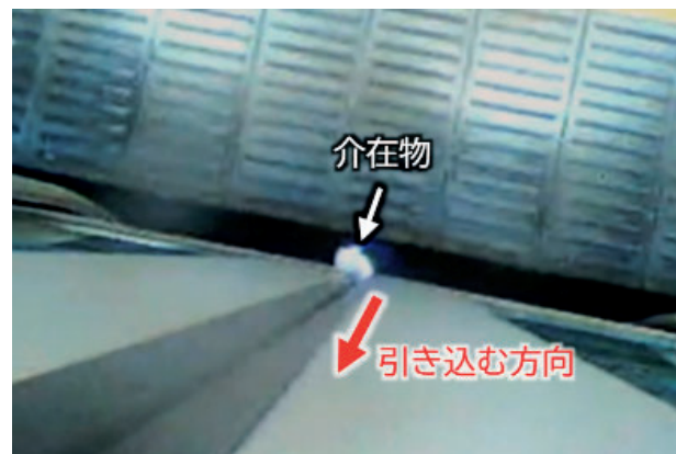
図5 実車両で記録された介在物を引き込む状況
