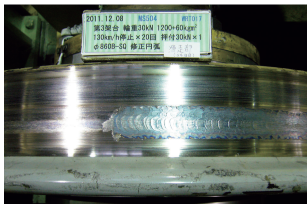
図1 台上試験で「作ってしまった」車輪滑走傷
