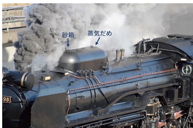
図3 D51形蒸気機関車のボイラー胴上の砂箱(サンドーム)、蒸気だめと一体化しており、先頭側が砂箱 提供: 後藤匠氏
