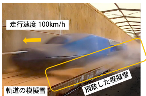
図3 模擬積雪軌道上の走行
