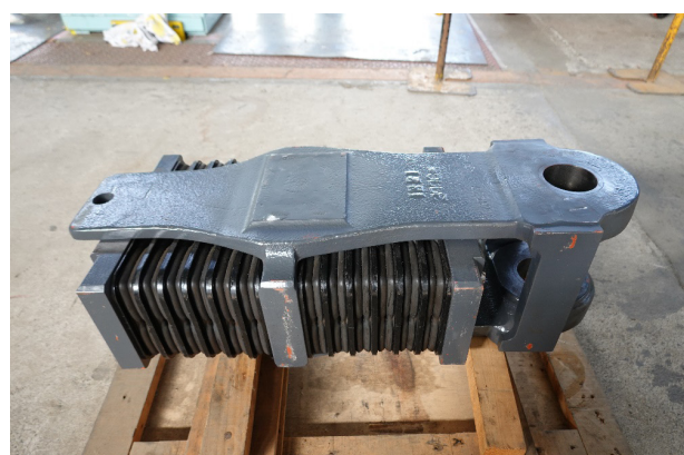
図2 ゴム緩衝器（ダブルアクション型）
